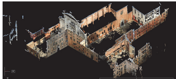
Abbildung 11. Punktwolke des Platzes aus 457 Fotos
