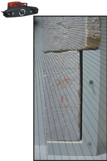
Aufnahme mit dem Streifenprojektionssystem
