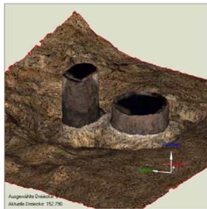
Texturiertes Modell eines Glühofens. Datenbasis: Laserscans sowie Digitalbilder
